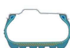
Una presión correcta garantiza un buen reparto de la presión de contacto con el suelo por lo tanto una adherencia y motricidad óptimas.
