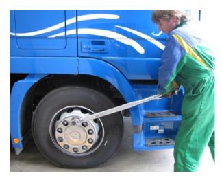
La fijación de una rueda o de una llanta sobre un buje o sobre un tambor es una operación que requiere una especial atención con el fin de garantizar óptimas prestaciones y sobre todo una máxima seguridad.
